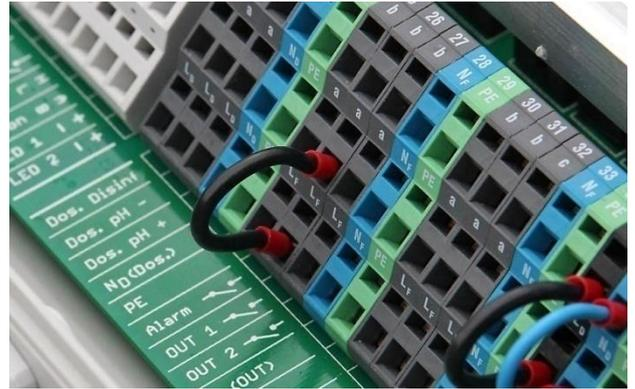
Drahtbrücke im Klemmraum von der Phase L<sub>F</sub> auf den Mittelkontakt a
