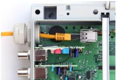
9. Schrauben Sie die Kabelverschraubung wieder gut fest, um eine zuverlässige Abdichtung zu erzielen.
