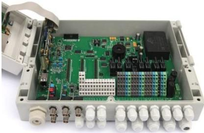
3. Lösen Sie die große Kabelverschraubung ganz links.
