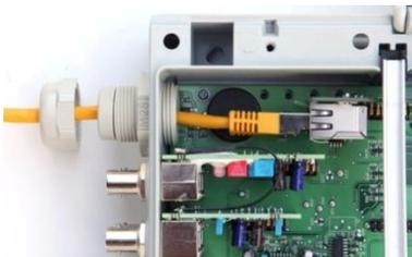
8. Drücken Sie die Gummidichtung in die Kabelverschraubung.
