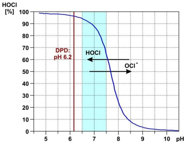
Werden Kontrollmessungen mit der DPD-Methode durchgeführt, so ist es wichtig, zu wissen, dass die DPD-Messung stets bei einem pH-Wert von ca. 6,2 stattfindet. Dies wird durch einen integrierten pH-Puffer in den DPD-Reagenzien erreicht. Die DPD-Messung misst daher, unabhängig vom tatsächlichen pH-Wert im Becken, stets das gesamte freie Chlor.
