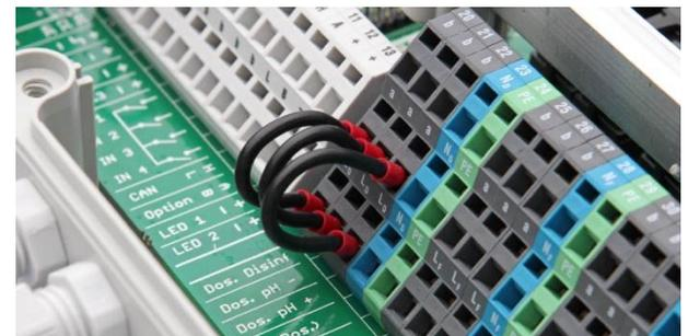
Drahtbrücken im Klemmraum von der Phase L<sub>D</sub> auf die Mittelkontakte a der Dosierausgänge
