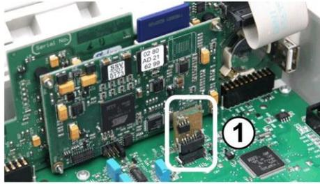
Das Konfig-Modul ist in einen Stecksockel eingesteckt und kann so leicht ausgetauscht oder in ein anderes Gerät gesteckt werden.
