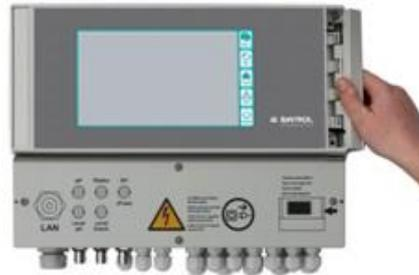
2. Entnehmen Sie die Abdeckblende und haken Sie das Scharnier unten aus.
