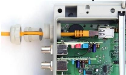
5. Stecken Sie zunächst das Kabel durch den Deckel der Kabelverschraubung und durch die Verschraubung selbst.
